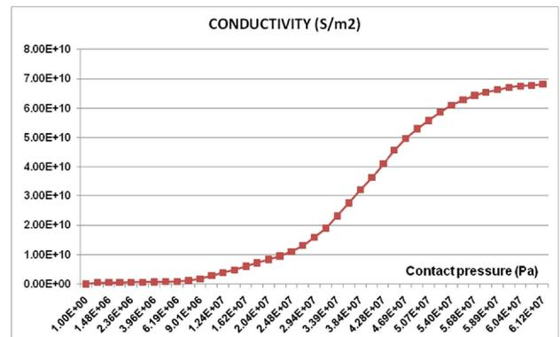
Fig. 5. Contact resistance.<sup>6</sup>
