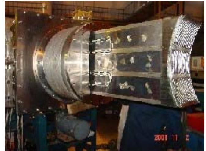
**1MW 2.45GHz LHCD launcher**
