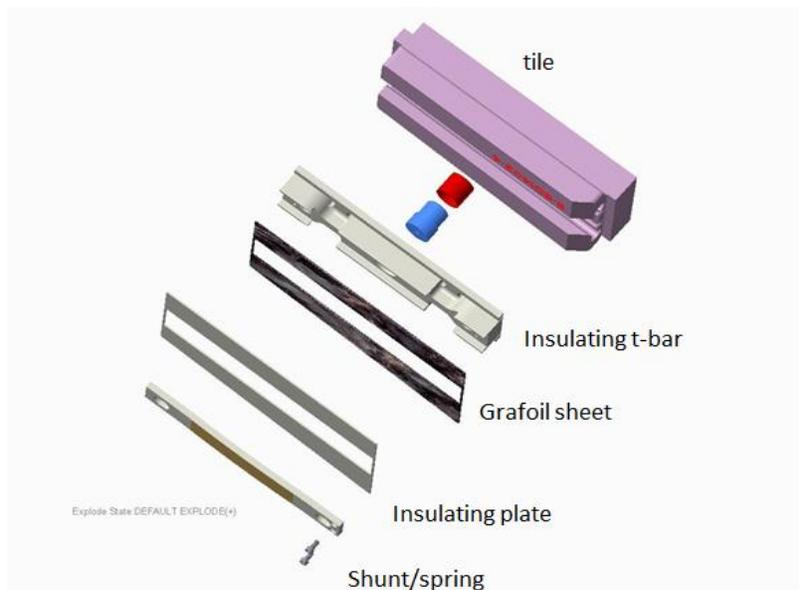
**Fig. 1.4.10:** Shunt tile for OBD 3,4,5.
