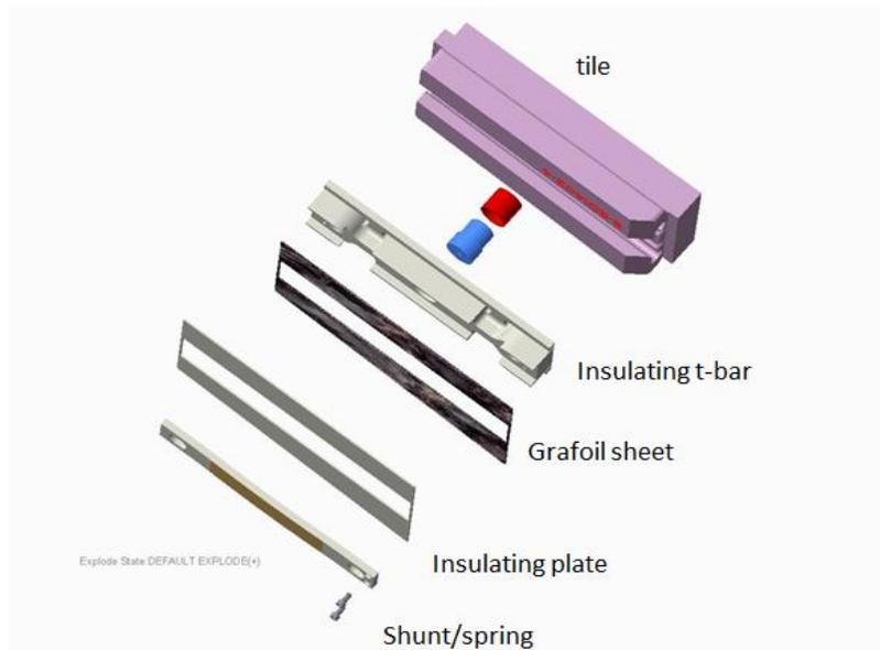
Fig. 1.4.10: Shunt tile for OBD 3,4,5.
