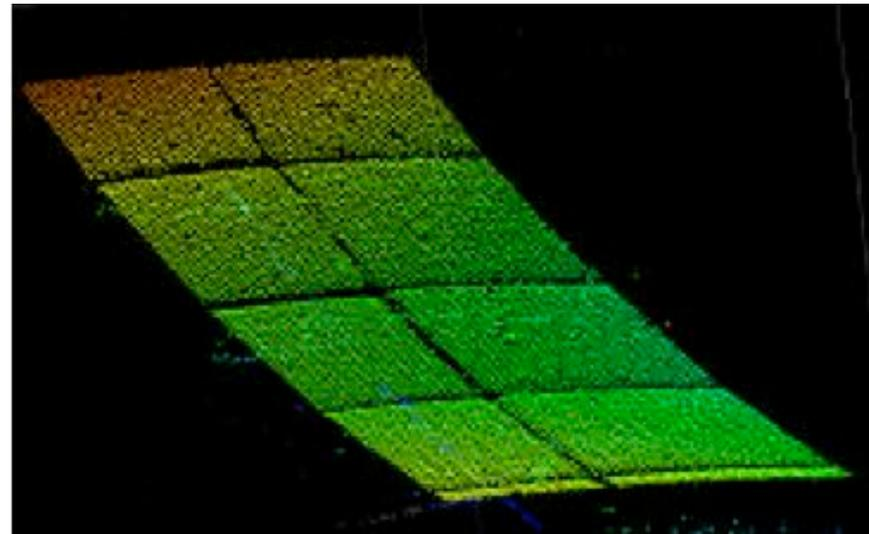
Laser rangefinder scan of 8 TFTR tiles (Menon et al.)
